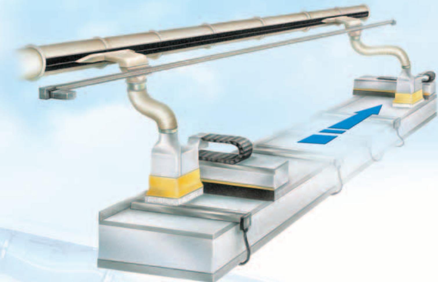
Über dem Bearbeitungszentrum befindet sich ein Lippenrohr mit einem Schiffchen. Die Späne werden vom Absauganschluss über einen kurzen, flexiblen Schlauch durch das Schiffchen in das Lippenrohr abgesaugt. Der Verfahrensweg des Werkzeugschlittens wird über Sensoren aufgenommen und auf den Antrieb des Schiffchens übertragen. Somit kommt es zu keiner zusätzlichen Beanspruchung der Schlittenführung durch die Absauganlage.
